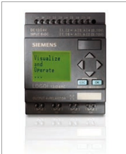
Obr. 1. Základní jednotka modulu Logo! nabízí ve verzi OBA6 čtyři analogové vstupy
