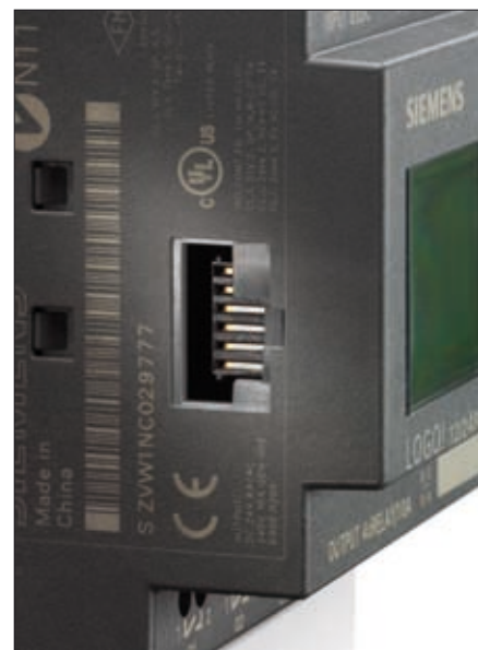
Obr. 3. Detailní pohled na konektor pro připojení externího textového displeje Logo! TD
